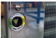
Bei steckerfertigen Geräten sind die Rohrleitungen fix mit dem Kälteaggregat verbunden und der Kältekreislauf mit Kältemittel gefüllt. Vitrinen mit Expansionsventil und solche ab einer bestimmten Größe verfügen über ein Schauglas mit Feuchteindikator (zur Kontrolle im Servicefall), dieses befindet sich seitlich am Kondensator. Bei steckerfertigen Geräten mit Kältemittel Propan (R290) ist kein Schauglas vorhanden.
