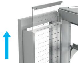
Heben Sie die Luftführungen nach oben aus der Flügeltür / Rückwand und reinigen Sie diese nach Intervallen laut Kapitel 4.1.1 unter Verwendung der vorgeschriebenen Reinigungsmittel laut Kapitel 4.1.2. Setzen Sie diese nach beendeter Reinigung wieder korrekt in die Montagehalterung ein.
