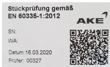
Das Gerät ist zusätzlich durch das AKE Prüfzeichen gekennzeichnet. Das AKE Prüfzeichen befindet sich am Unterbau oder an der Steuereinheit (modellabhängig).
