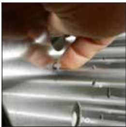
A1. Retirer les clips en plastique du côté droit des tiges en aluminium
