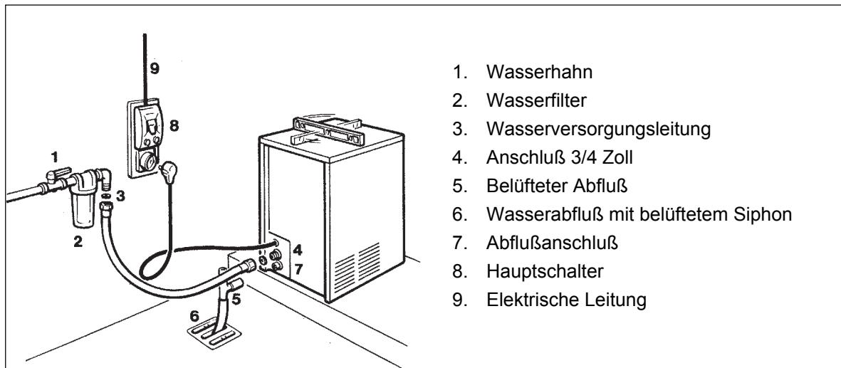
**ACHTUNG.** Dieser Eisbereiter wurde nicht für die Installation im Freien oder für den Betrieb bei Raumtemperaturen unter 10 °C oder über 43 °C entwickelt. Dasselbe gilt für die Wassertemperatur, die nicht unter 5°C oder über 35°C liegen darf.
