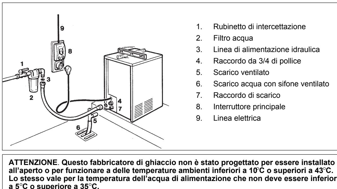
**ATTENZIONE.** Questo fabbricatore di ghiaccio non è stato progettato per essere installato all'aperto o per funzionare a delle temperature ambienti inferiori a 10°C o superiori a 43°C. Lo stesso vale per la temperatura dell'acqua di alimentazione che non deve essere inferiore a 5°C o superiore a 35°C.
